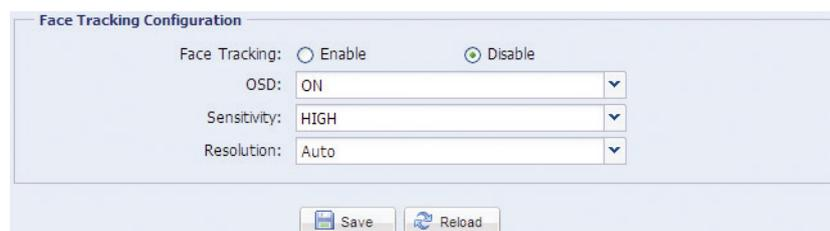
ÉTAPE 1 : Cliquez sur "Config." pour entrer dans la page configuration du système, et sélectionnez "Camera" → "Face Tracking" (Caméra → Suivi du visage).
